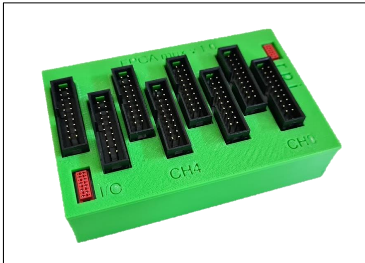
2.3. att. RTU izstrādāta FPGA bāzēta iekārta paralēlai sensoru nolasīšanai
